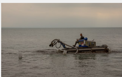
Kis kotró pumpálja az iszapot a víztelenítő zsákok felé.
