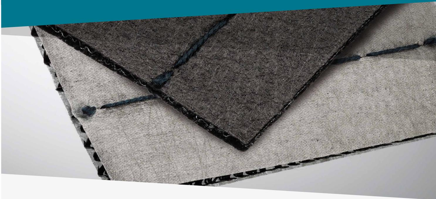
**Enkadrain Wide besteht aus einem 5 m-breiten dreidimensionalen Dränkörper aus Monofilamenten, der ein- oder beidseitig mit einem thermisch oder mechanisch verfestigten Vliesstoff bzw. einem Gewebe verbunden ist. Das Produkt ist eine vielseitige und zuverlässige Dränmatte für Deponien und großflächige Infrastrukturmaßnahmen.**
