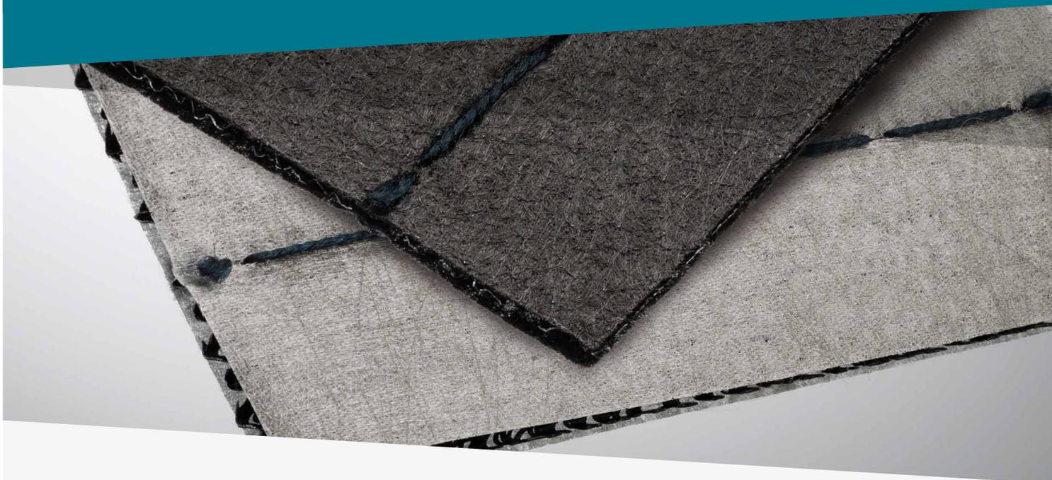
**Enkadrain Wide est un géocomposite de drainage constitué d'une âme drainante monofilament tridimensionnelle de 5 m de large associée à un ou deux géotextiles tissés ou non tissés. Ce produit est un géocomposite polyvalent et performant destiné au drainage des installations de stockage de déchets et aux grandes infrastructures**
