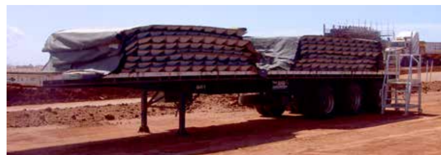
A 2,6 m széles rugalmas beton matracok szállítása
