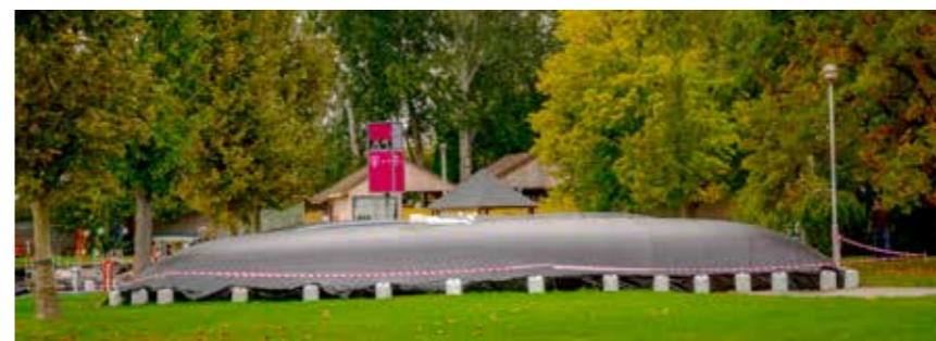
Két kisebb zsákot 2,3 m magasságig töltötték meg. A legnagyobb zsák a két kisebb tetejére került.
