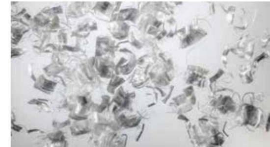
Crackstop® Mikrofasern (Adfil Produktprogramm)
