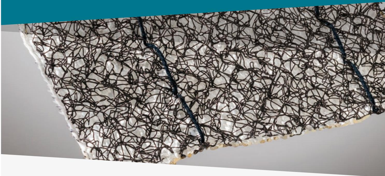
**Enkamat W besteht aus einer offenen dreidimensionalen Höckerprofil-Strukturmatte und einem Bewehrungsgewebe. Beide Komponenten sind werkseitig miteinander vernäht. Enkamat W kommt zur Begrünung steiler oder felsiger Böschungen, auf Kunststoffdichtungsbahnen oder geosynthetischen Tondichtungsbahnen zum Einsatz.**
