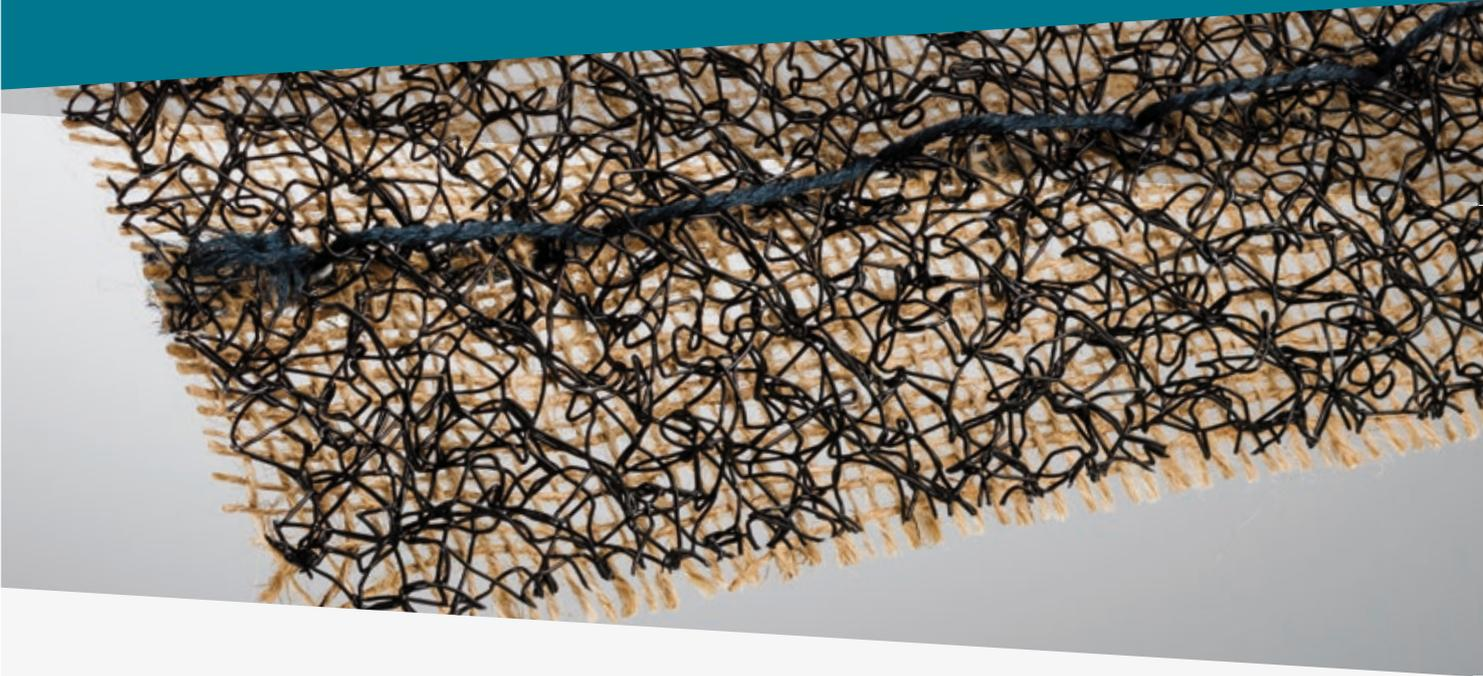
**Enkamat J besteht aus einer offenen dreidimensionalen Höckerprofilstrukturmatte und einem biologisch abbaubaren Jutegewebe. Beide Komponenten sind werkseitig miteinander vernäht. Enkamat J wird an Böschungen, Dämmen und Ufern eingebaut.**
