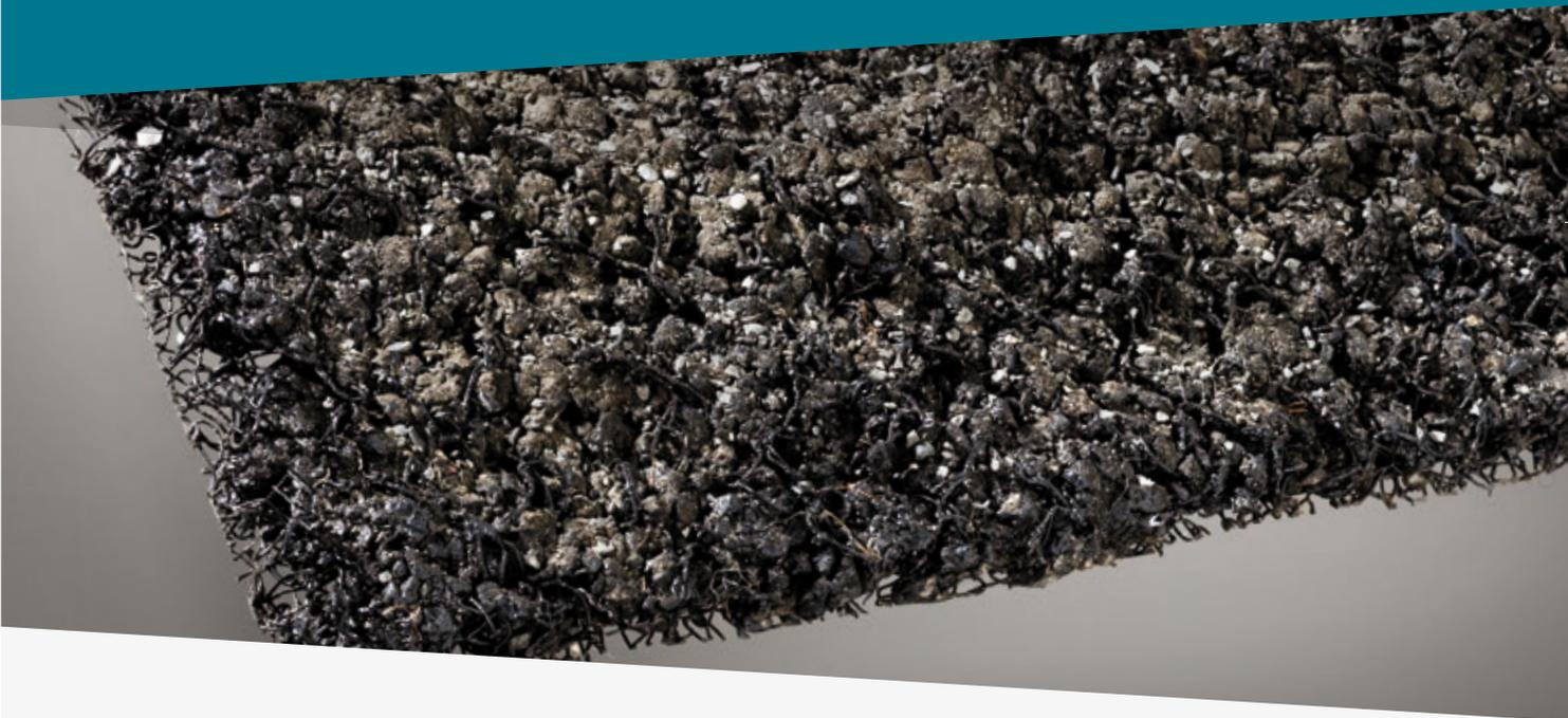
**Enkamat A20 ist eine dreidimensionale Matte aus Polyamid-Monofilamenten, deren offene Höckerprofilstruktur werkseitig mit einem Bitumen-Mineral-Gemisch verfüllt ist.**
